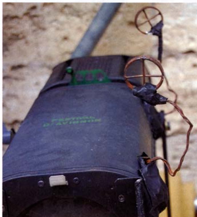
Détail d'un système "viseur à distance" pour le réglage des projecteurs - Photo Philippe Warrand
