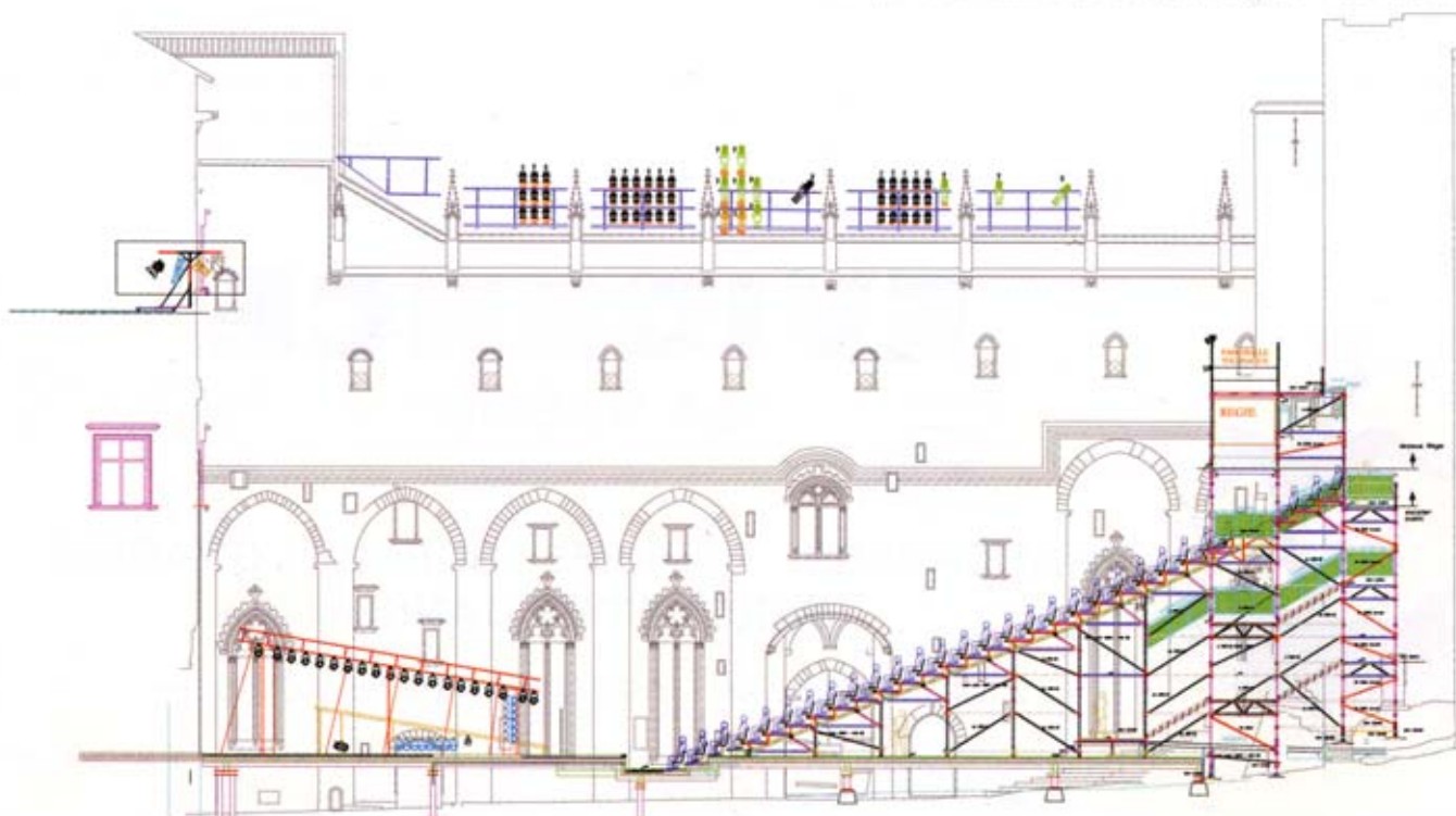
Coupe d'implantation lumière pour Le Roi Lear à la Cour d'Honneur - Plan Festival d'Avignon
